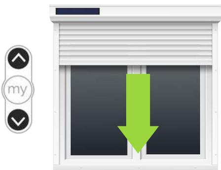
2. Appuyer simultanément sur les touches **MY** et **DESCENTE** jusqu'au mouvement du volet roulant. **LA FIN DE COURSE HAUTE EST MÉMORISÉE.**
