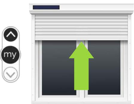
4. Appuyer simultanément sur les touches **MY** et **MONTÉE** jusqu'au mouvement du volet roulant. **LA FIN DE COURSE BASSE EST MÉMORISÉE.**
